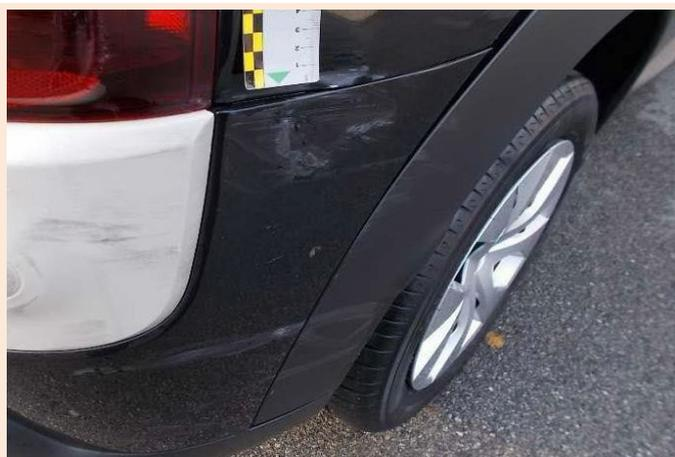
**ELEMENTI DI MATERIALE PLASTICO VERNICIATO:** Scalfittura/Abrasione di dimensione massime complessive superiori a 10 cm senza intacco del film di vernice e/o in numero superiore alle 3 unità per elemento. Tutti i graffi o attriti, di qualsiasi lunghezza, con asportazione di materiale; qualsiasi deformazione e/o incisione.
