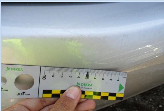
ELEMENTI DI MATERIALE PLASTICO VERNICIATO: Scalfittura/Abrasione di dimensione inferiore a 10 cm senza intacco del film di vernice e/o in numero massimo alle 3 unità per elemento. Nessuna presenza di asportazione di materiale e/o di deformazioni e/o incisioni.
