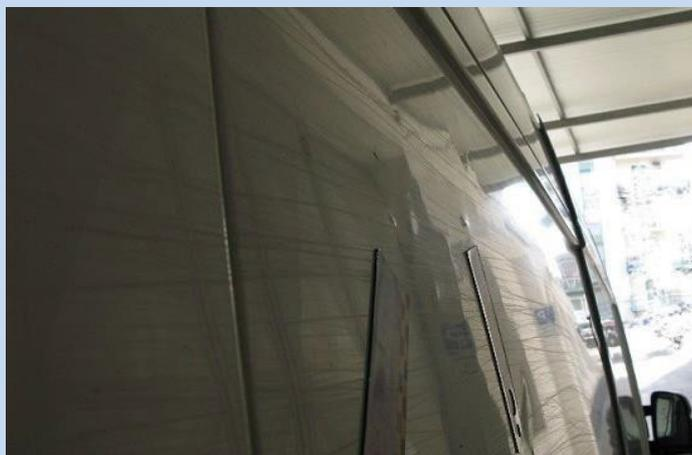
Piccole deformazioni positive o negative delle parti interne di carrozzeria inferiori al 25% dell'area e non compromettano la funzionalità/sicurezza.
