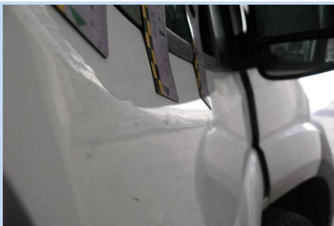
Massimo n. 5 bolli di dimensioni minori a 10 mm e senza sbocco del film di vernice.
