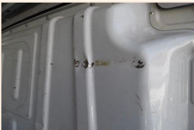
Abrasioni o graffi con principio di corrosione
