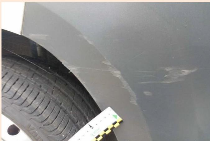
**ELEMENTI DI MATERIALE PLASTICO NON VERNICIATO:** Abrasione/Riga di estensione massima superiore a 10 cm e/o di numero superiore alle 3 unità per elemento. Qualsiasi deformazione e/o incisione.
