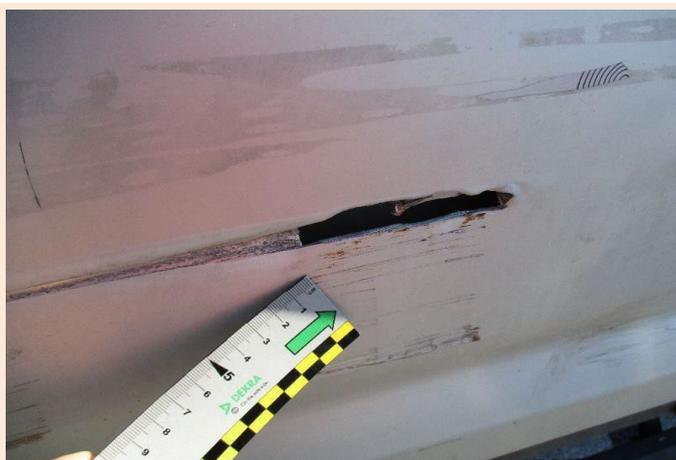
Non accettate ammaccature e/o rientranze che compromettono la funzionalità/sicurezza dell'elemento.
