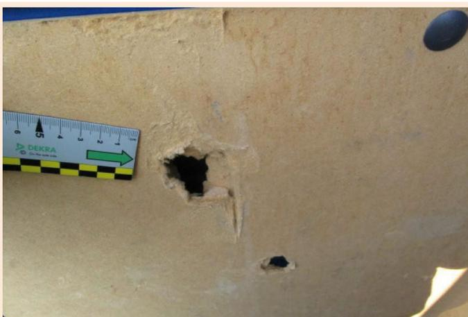
Fori, strappi, lacerazioni, gravi deformazioni del pavimento di carico o dei relativi rivestimenti
