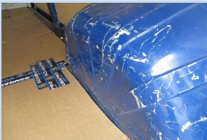
Graffi e/o abrasioni senza principio di corrosione
