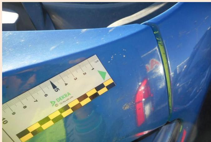
Scheggiature di dimensioni maggiori a 3 mm e superiori a 30% dell'area dell'elemento. Qualsiasi scheggiatura che abbia intaccato il film di vernice, con principio di corrosione
