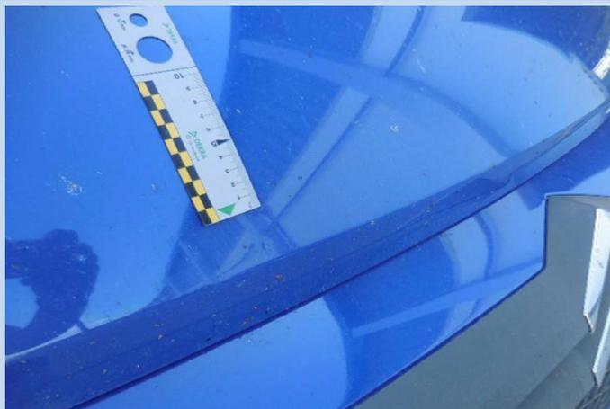
Scheggiature di dimensioni inferiori a 3 mm e inferiori al 30% dell'area dell'elemento. Nessun danneggiamento al film di vernice e/o principio di corrosione.
