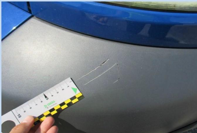
ELEMENTI DI MATERIALE PLASTICO NON VERNICIATO: Abrasione/Riga di estensione inferiore a 10 cm e/o di numero massimo alle 3 unità per elemento. Nessuna deformazione e/o incisione.
