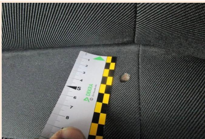
Bruciatura con diametro > 10 mm. Sarà prevista sempre la sostituzione dell'elemento.
