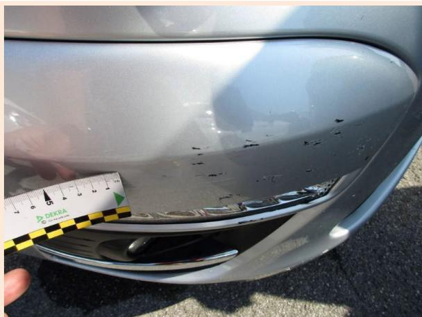
**ELEMENTI DI MATERIALE PLASTICO VERNICIATO:** Scalfittura/Abrasione di dimensione massime complessive superiori a 5 cm in numero superiore alle 3 unità per elemento. Tutti i graffi o attriti, di qualsiasi lunghezza, con asportazione di materiale; qualsiasi deformazione e/o incisione
