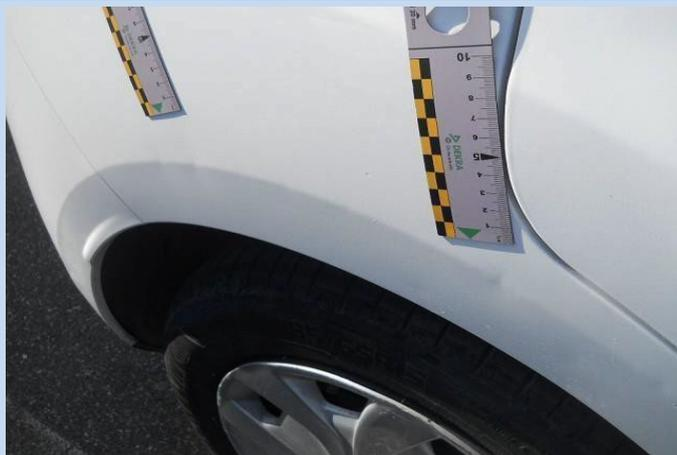
Massimo n. 5 bolli di dimensioni inferiori a 10 mm senza sbocco del film di vernice.
