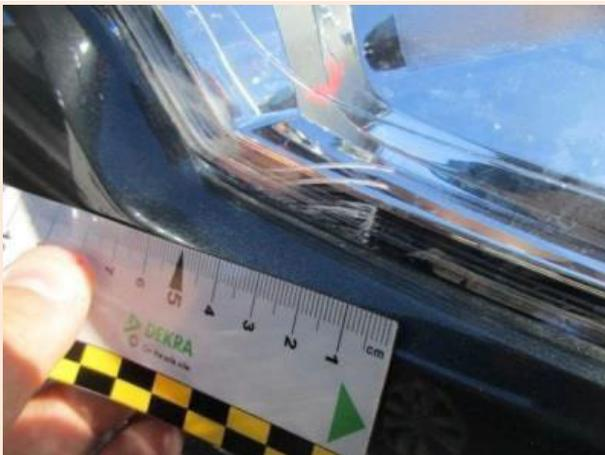
**PROIETTORE:** Lievi graffi, abrasioni o scheggiature superiori a 10 cm e/o superiori a 3 unità per elemento; (nei casi ove tecnicamente possibile, sarà valutata la riparazione a vantaggio della sostituzione);
