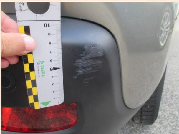
**ELEMENTI DI MATERIALE PLASTICO NON VERNICIATO:** Abrasione/Riga di estensione massima superiore a 5 cm e/o di numero superiore alle 3 unità per elemento. Qualsiasi deformazione e/o incisione.
