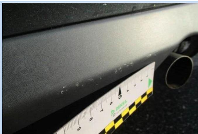
**ELEMENTI DI MATERIALE PLASTICO NON VERNICIATO:** Abrasione/Riga di estensione inferiore a 5 cm e/o di numero massimo alle 3 unità per elemento. Non dovrà essere presente nessuna deformazione e/o incisione.
