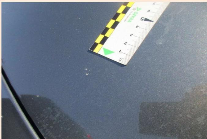
Scheggiature di dimensioni maggiori a 3 mm e superiori a 10 unità per elemento. Qualsiasi scheggiatura che abbia intaccato il film di vernice.
