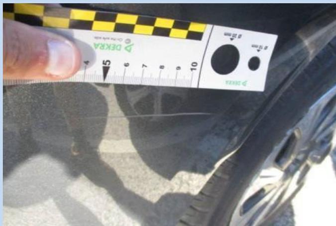
**ELEMENTI DI MATERIALE PLASTICO VERNICIATO:** Scalfittura/Abrasione inferiore a 5 cm e/o di numero massimo alle 3 unità per elemento. Graffi o attriti senza asportazione di materiale. Non dovrà essere presente nessuna deformazione e/o incisione.
