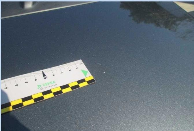
Scheggiature di dimensioni minori a 3 mm ed inferiori a n. 10 unità per elemento, il film di vernice non dovrà essere intaccato.
