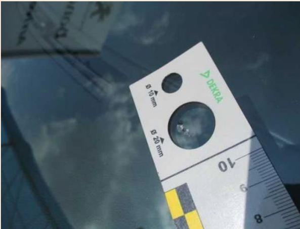
Scheggiatura sul parabrezza di dimensioni: inferiori o uguale ad 1 cm fuori dal campo visivo (qualora sia tecnicamente fattibile, sarà prevista la riparazione dell'elemento a vantaggio della sostituzione, con costo forfettario).
